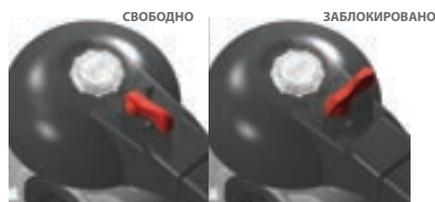
Благодаря многофункциональной рукоятке и красной кнопке управления, расположенной на рычаге, можно выполнить поворот 0°- 90° и пошаговый поворот с 10 промежуточными положениями и стопорной блокировкой: рукоятку можно заблокировать в любом из 10 положений, просто нажав на кнопку управления Free-Lock. КРОМЕ ТОГО, можно установить на рукоятку навесной замок для защиты оборудования от несанкционированного доступа.
