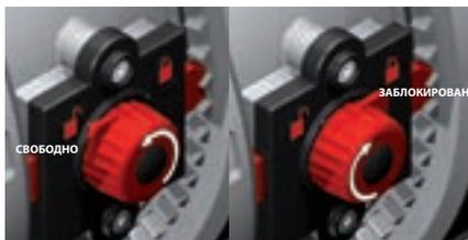
При повороте кнопки влево с ориентацией стрелки на изображение открытого замка устройство DUAL BLOCK® устанавливается в положение разблокировки: накидные кольца крана свободно вращаются по часовой стрелке и против часовой стрелки.
